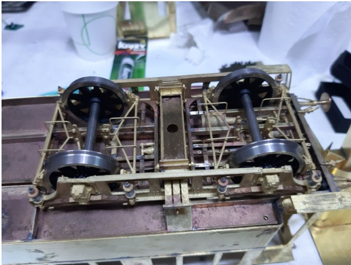
Die Drehgestelle der GB besaßen jeweils den integrierten Wd-Bremszylinder der Unterteil des war praktisch nur mit den 4 Kant-Stahlträger, den Traversen und den Batterie-Kasten (für die Beleuchtung) bestückt. Bei den Nachfolge-Versionen wurde die Beleuchtung mittels Gas ausgeführt (Gastanks unter dem Wagenboden)
