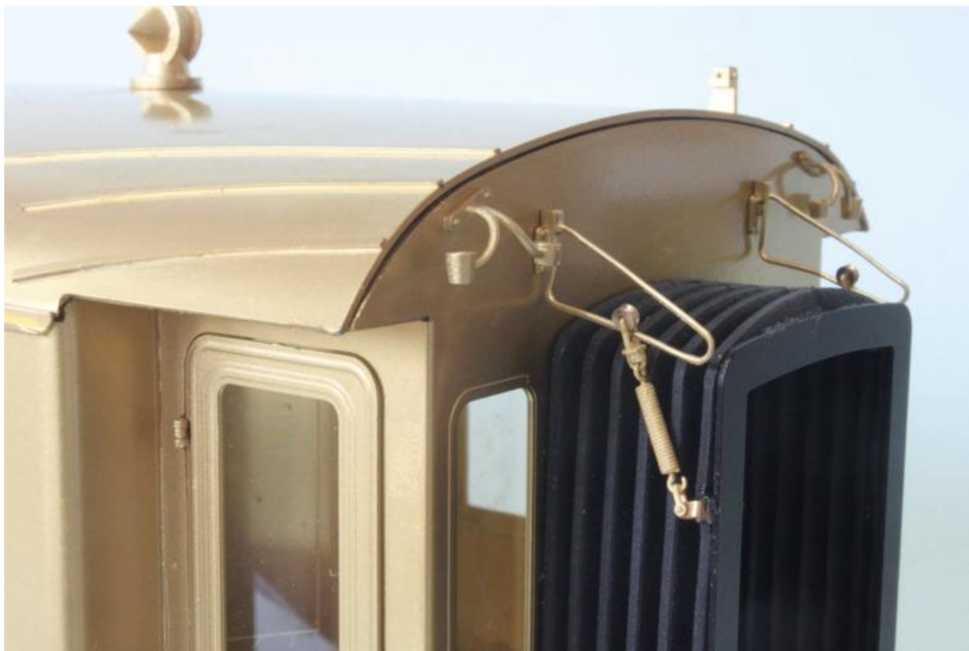
Faltenbalgführung (Rollen), Signalhalter nach europäischen Normen, Wagenkasten im Aufbau (Dach abnehmbar)
