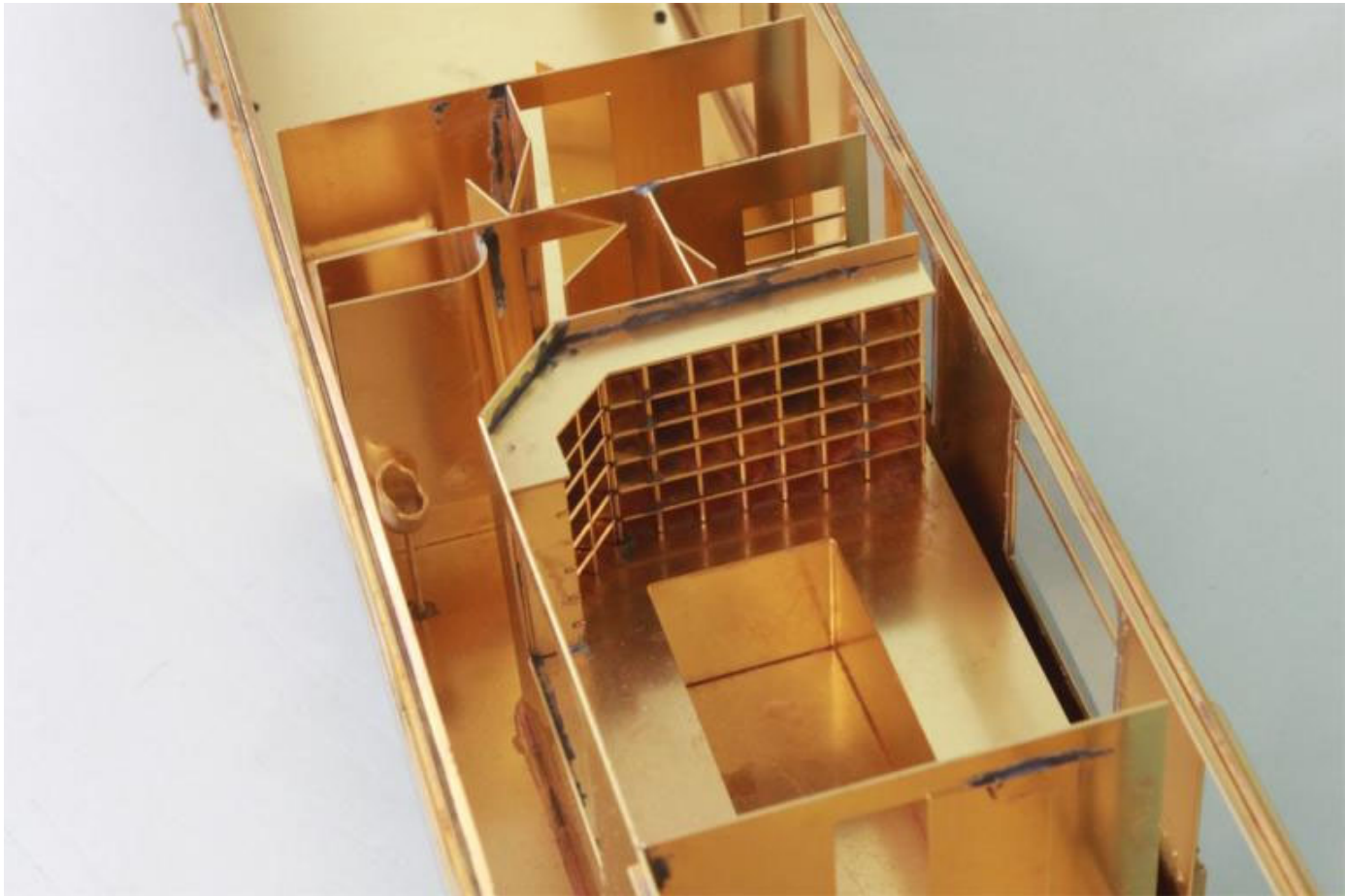
Innenausbau des Postwagens (noch im Aufbau)
