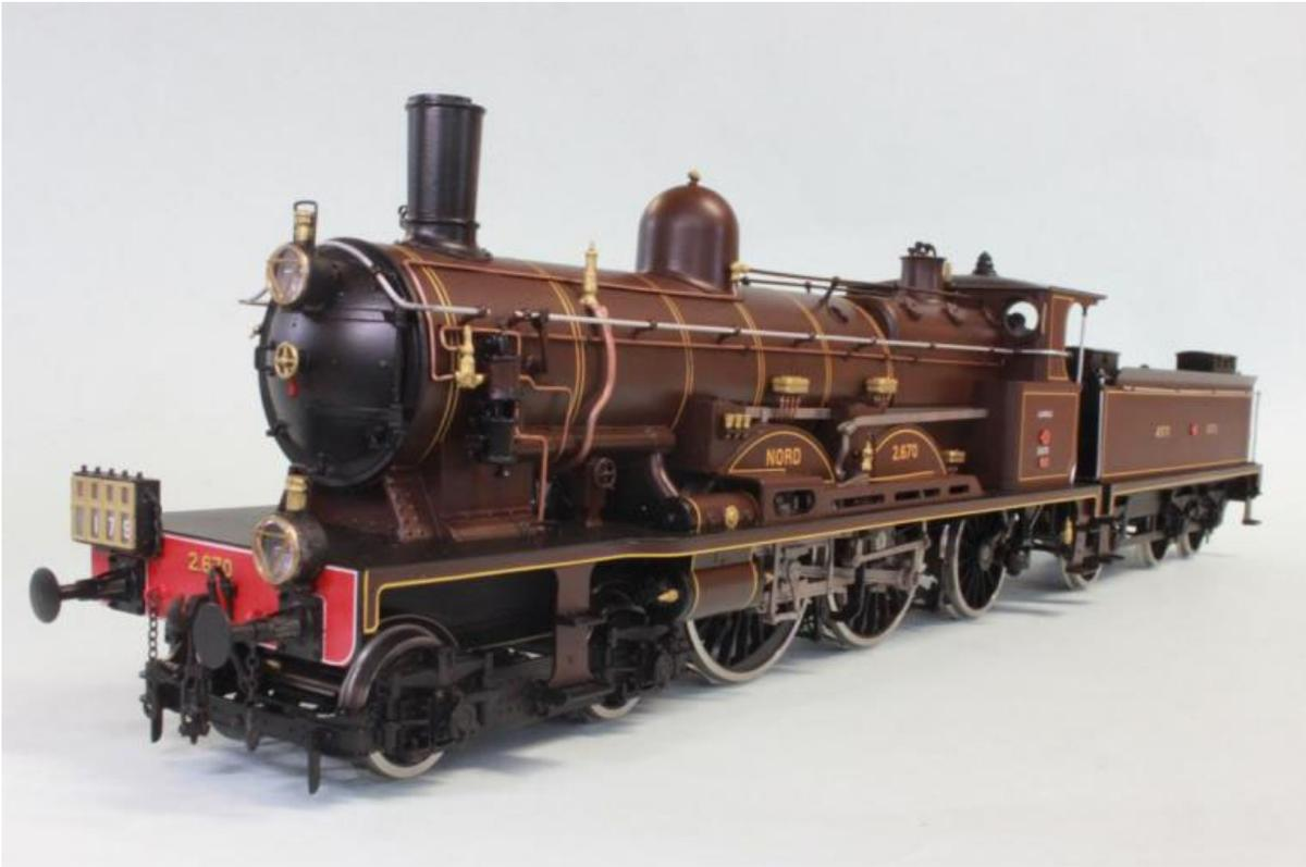
**NORD 2.670 "Atlantic", Originalmaschine (steht im Museum in Mühlhausen), mit original Tender. Die Lok ist in der typischen NORD Farbgebung; braun mit gelben Zierlinien und zum Teil Kupferleitungen, Kompressor auf der linken Seite, Zuglauf-Nummer 179, Produktion: Total 11 Maschinen**
