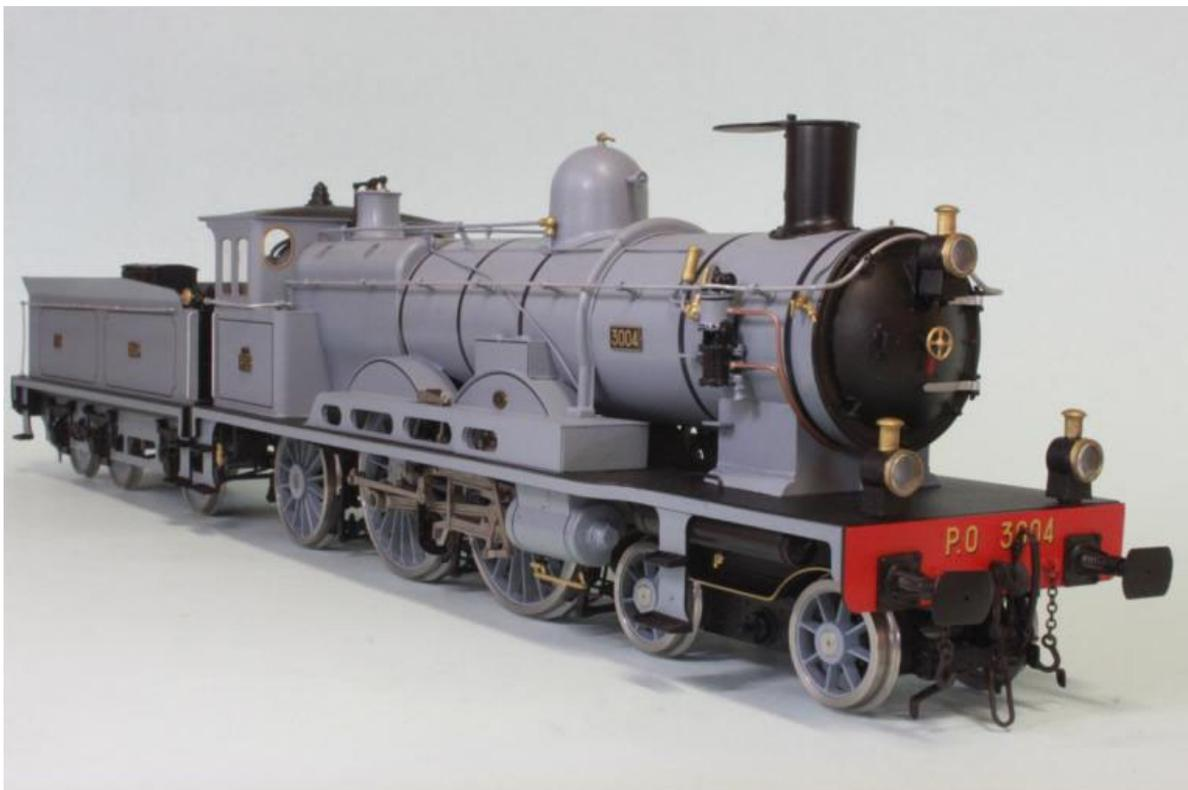
**P.O. 221-3004 mit original Tender um 1907, bereits "geschlossene Kabine mit Fenster", Maschine des "Süd-Express". Die Lok ist in PO grau mit dunkelblauen, Zierlinien, rote Pufferbohlen, Kompressor auf der rechten Seite. Eine estetisch wunderschöne Lok, Produktion: Total 6 Maschinen**
