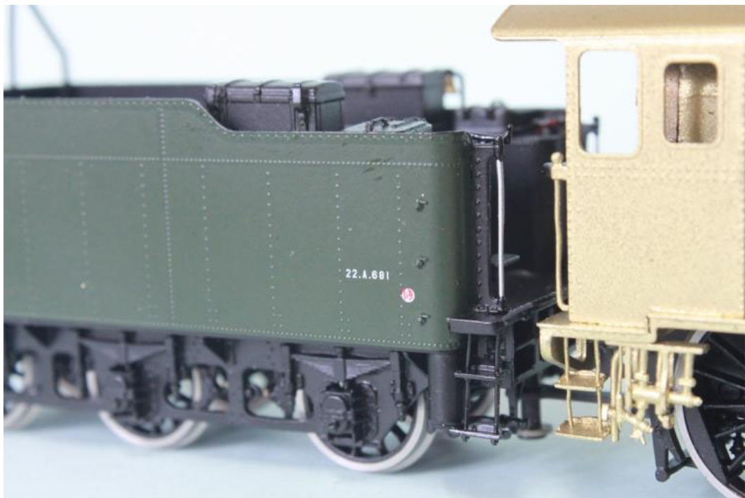
Immatriculation SNCF peinte en blanc, Tender 22A, machine SNCF verte, cette machine fait partie de la tranche 230 B 611 à 790 (ex EST 3611 à 3790) quant aux tender 22 A 602 à 890
