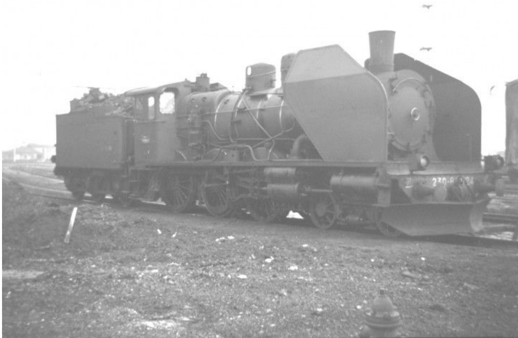
Machine SNCF 1-230 B no 624 "grandes oreilles", remarquable le chasse neige avant de la machine
