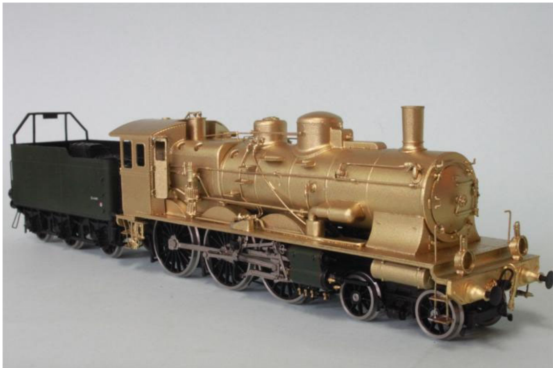
SNCF 1-230 B no 681 notre Art.no.: 2280 (Dépôt de BELFORT), avec tender 22A, cette machine à déjà les modification tube vapeur tubulaire plus div. tuyauteries, domes, etc., etc.. Cette machine date de 1955 et est en couleur SNCF verte mais encore sans plaque (immatriculation peinte), notre Art.no.: 2280
