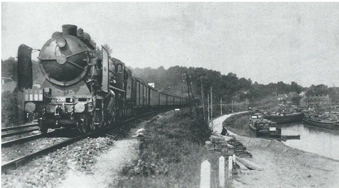
NORD 231 no 1238 avec pare-fumées (similaire Art.no. 2269/1) encore plus puissante; 1933, puissance de 2070 ch, direction Orry-la-Ville, en 5mm/m en pente; 135 km/h
