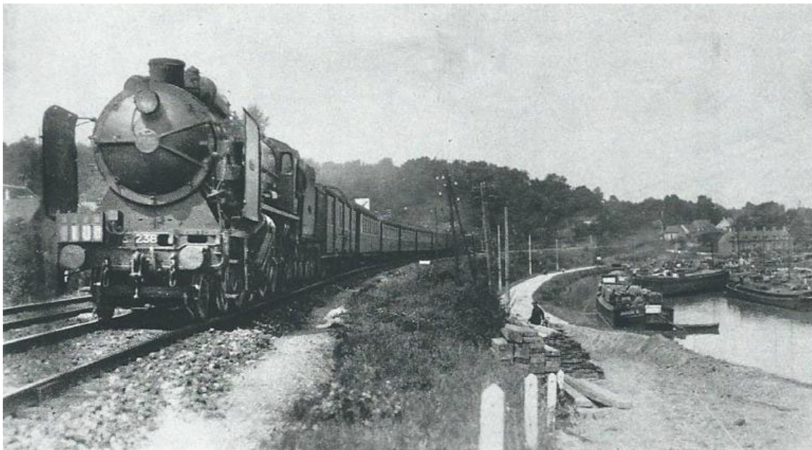
NORD 231 no 1238, Zug no 105, mit Windleitblechen (wie unsere Art.no. 2269/1) noch schneller, noch leistungsfähiger; 1933, mit 2070 PS, auf dem Weg nach Orry-la-Ville, mit 5mm/m Steigung; 135 km/h
