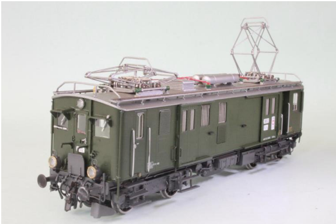
Art.no. 2268 SBB/CFF Fe 4/4 no 18512, Ursprungsversion mit Email-Tafeln und Stangenpuffer von ca. 1929, Kreis I, alte Bremsanlage
