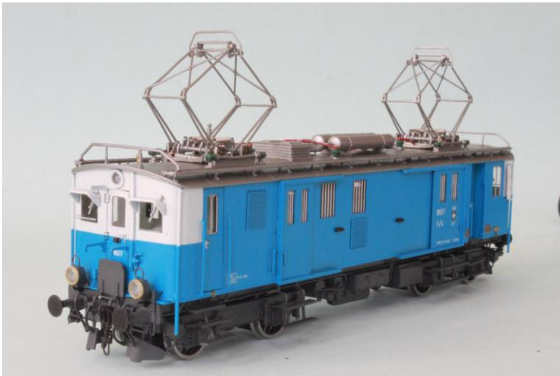
Art.no. 2268/3 SBB/CFF Fe 4/4 no 18517, original Version von 1930 für den Betrieb Olten-Basel als "Arbeiter-Pulman-Express", Stangenpuffer, original Beschriftung. Der Gepäcktriebswagen war nur ungefähr 2 Jahre in dieser Version in Betrieb.
