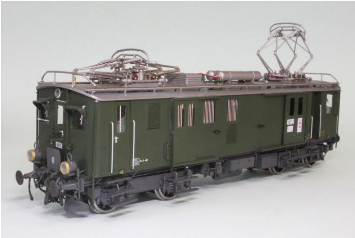
Seite Führerstand 2 des Ur-Prototypen, natürlich noch mit Stangenpuffer, Email-Tafeln an der Frachttüre, übrigens; der Tachycounter Antrieb fehlt noch an den Prototypen (unsere Art.no.: 2268)
