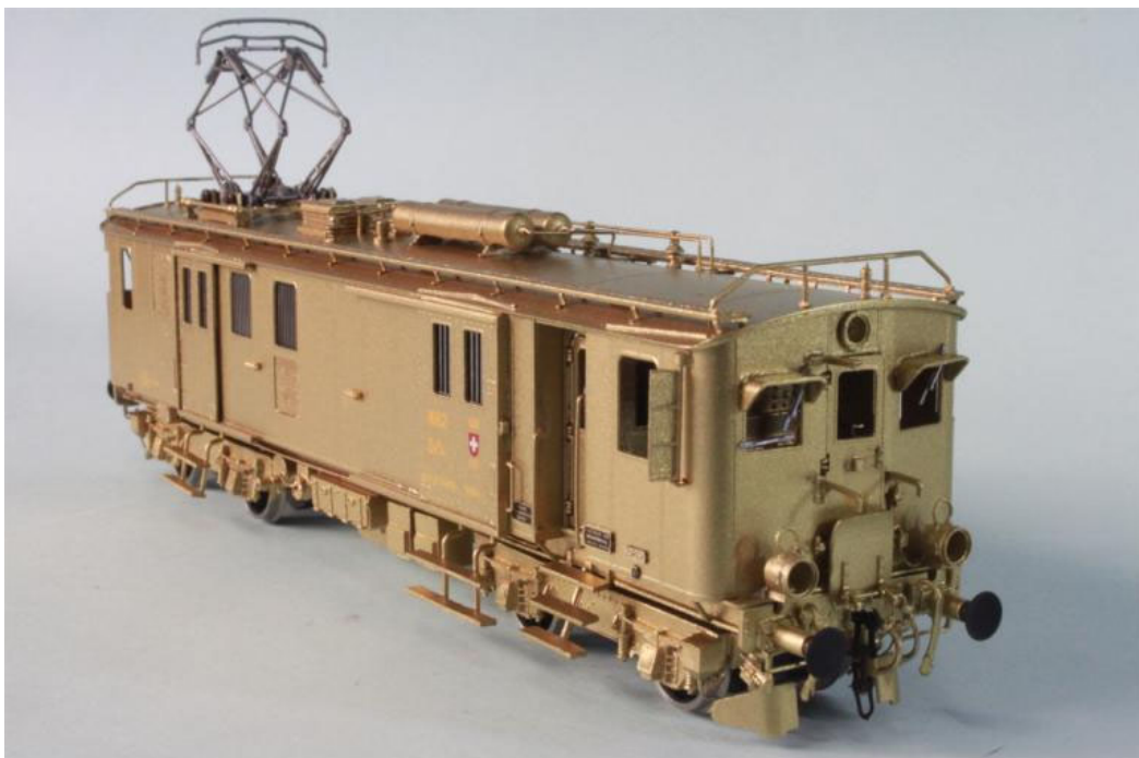
Prototyp des SBB/CFF De 4/4 no 1662, "Seetaler", braun/rot, Umbauversion mit linksseitigem Seitenfenster (wie no 804), Hülsenpuffer, elektrisches Bremssystem, Lampen noch mit Messingring, Jahrgang 1964, unsere Art.no.: 2268/5
