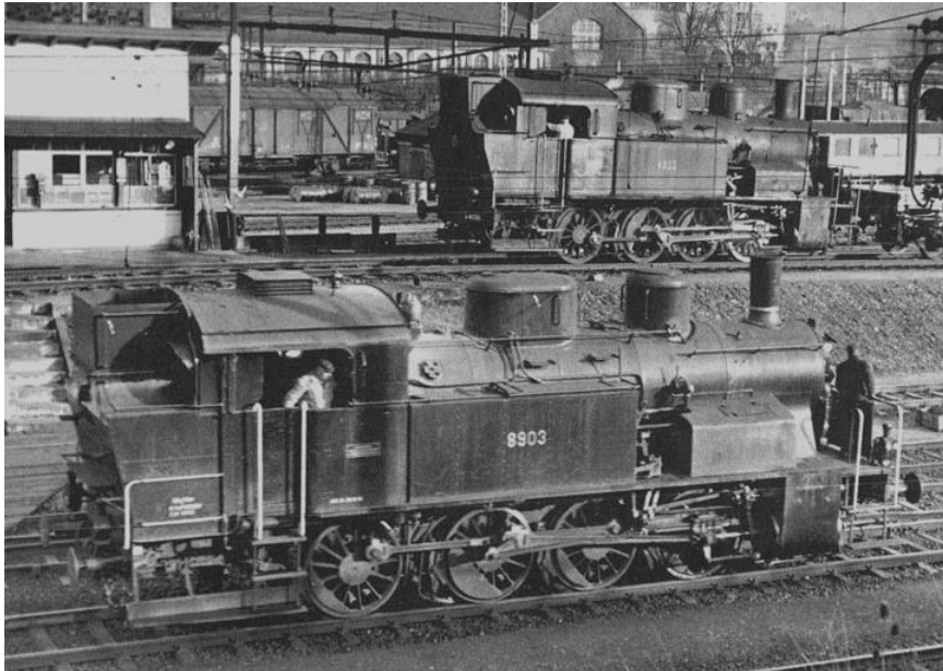
E 4/4 no 8903 am Ablauffberg in Basel, gut zu erkennen sind die gelben Griffstangen und Abdeckung des Dampfzylinders der Umsteuerung (Art.no.: 2254/4). Im Hintergrund die E 4/4 8902
