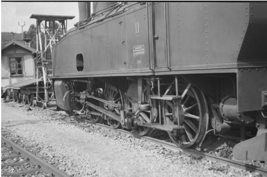
Fahrwerk linke Seite der Ec 4/5 (SMB noch unbeschriftete Version), Art.no.: 2281
