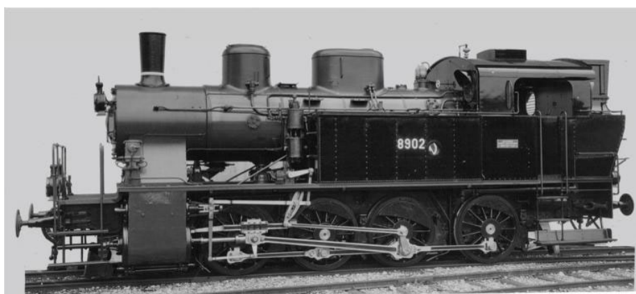
SLM Werkbild von 1930, eine der ersten umgebauten C 4/5 zu einer E 4/4 (Art.no.: 2254/3)
