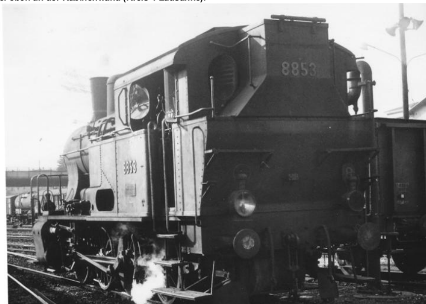
Art.no.: 2254/1 E 4/4 no 8853, gut sichtbar der besagte Kohlensatz und die Trittstufen zur Befüllung.
