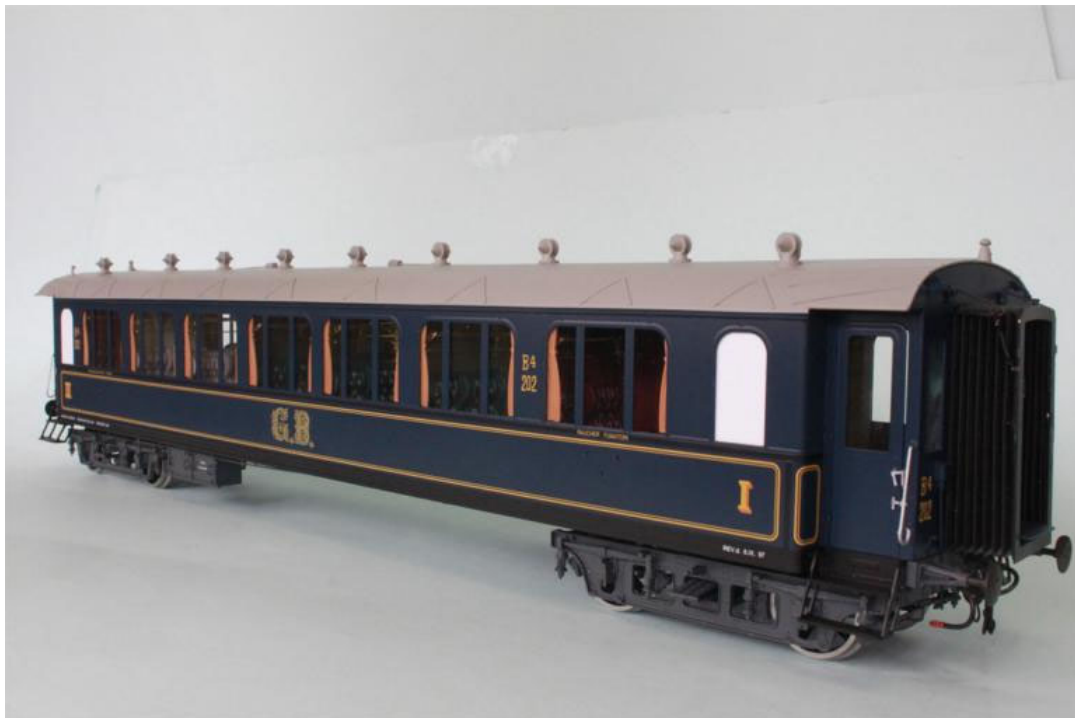
Hier der gleiche Wagen AB 4 no 202 aber Sicht von der 1. Klasse her, Gangseitig mit Toilette deshalb B4 es ist dies übrigens der einzige Wagen der Gotthardbahn, der 2 Toiletten bestückt war.
