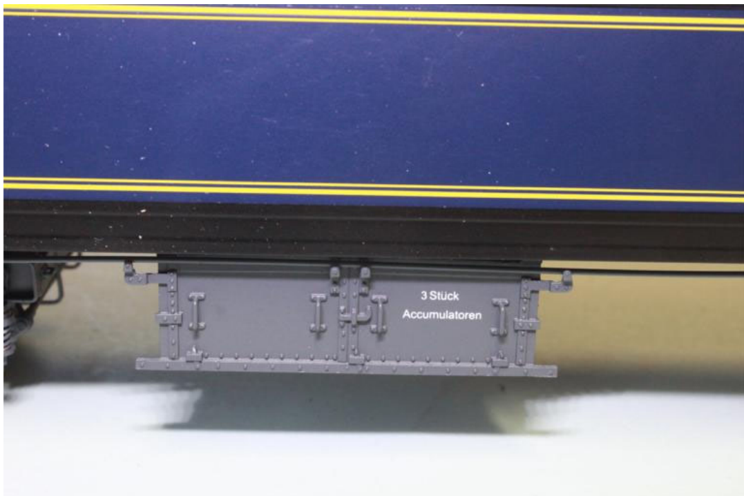
Auf jeder Seite der Wagen befanden sich die Akkumulatoren-Kasten. In diesen Waren je 6 Batterien verbaut (für die Beleuchtung der Wagen). ie Akkus wurden kontinuierlich durch den Dynamo im Drehgestell geladen. Die Heizung des 1. Klasse Wagen wurde mittels Gas betrieben, später zur SBB-Zeit wurden dann auch Versuche mit gasbetriebener Beleuchtung gemacht; die Wagen hatten dann 2 riesige Gastanks unter dem Wagenboden.
