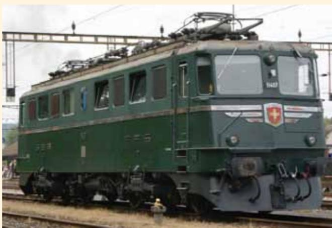
A partir de 1945 le trafic au Gothard ainsi que sur d'autres réseaux s'intensifie. On était à la recherche d'une locomotive puissante et qui pouvait rouler à 75km/h. En 1955 les premières livraisons de Ae 6/6 eurent lieu et, jusqu'en 1966, toutes les machines furent construites. Ce type de locomotive devint rapidement un point culminant dans l'histoire des chemins de fer suisses.
